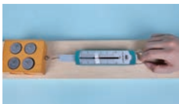
图 3.2-4 测量静摩擦力的实验装置
