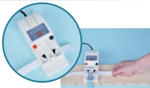
图 1.2-8 使用电火花打点计时器
